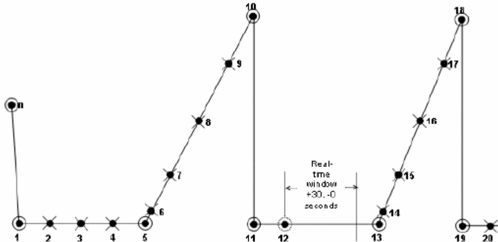
Предположим, что точка 0 уже сохранена в архиве. Прежде чем принять очередное решение о записи данных, система ожидает прихода двух точек. При получении точки с номером 2 подсистема сохранения вычисляет изменение угла наклона по следующим формулам. Угол0\_1 – начальный угол, Угол1\_2 – текущий угол.
